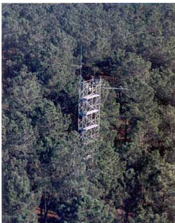
**Figure 19.** Tour à flux pour mesurer les échanges gazeux (vapeur d'eau,  $CO_2$ ) entre une forêt de *Pinus pinaster* et l'atmosphère au Portugal. Photo : J. Soares David.
