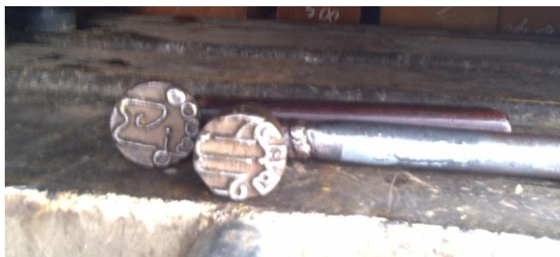
ภาพที่ 1: ค้อนตีตราประทับไม้ของกรมป่าไม้ (ปม.) ซึ่งพนักงานเจ้าหน้าที่ป่าไม้จะใช้การตีตราบนท่อนซุง และไม้แปรรูป
