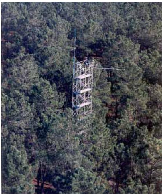
**Figura 19.** Torre de eddy-covarianza para evaluar el intercambio gaseoso (vapor de agua y  $CO_2$ ) entre el bosque de *Pinus pinaster* y la atmósfera en Portugal. Foto de J. Soares David.
